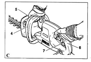
Držte jednou rukou přední rukojeť (C/4) a zmáčkněte pojistku předního držadla (C/5).  Uchopte druhou rukou zadní rukojeť (C6) a nůžky na živý plot spusťte pojistkou zadního držadla (C7).
